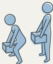
Heben schwerer Lasten mit gerader Wirbelsäule
